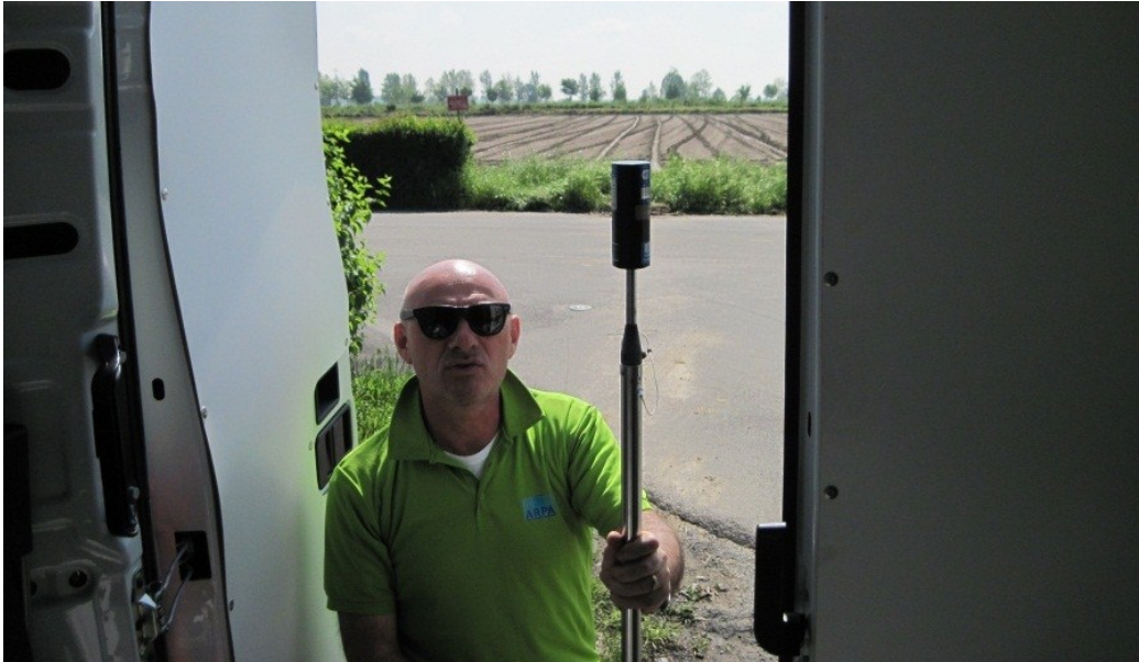
Figura 3. Operazione di calibrazione della catena fonometrica dell'analizzatore statistico Larson & Davis 870 montato sul laboratorio mobile di ARPA Lombardia.
