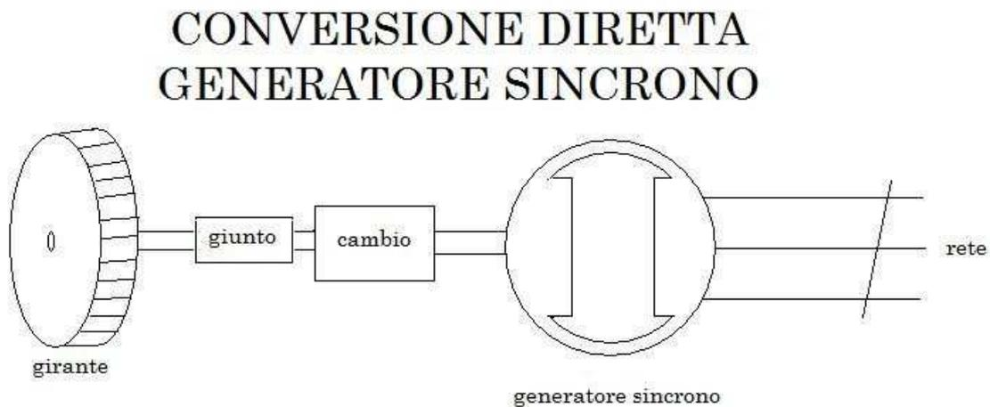
**Figura II.13 Schema a blocchi del sistema di conversione diretta a generatore sincrono.**
