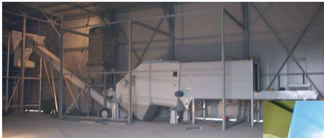
Sminuzzatore in fase di allestimento nell'impianto Arborea (esempio)
