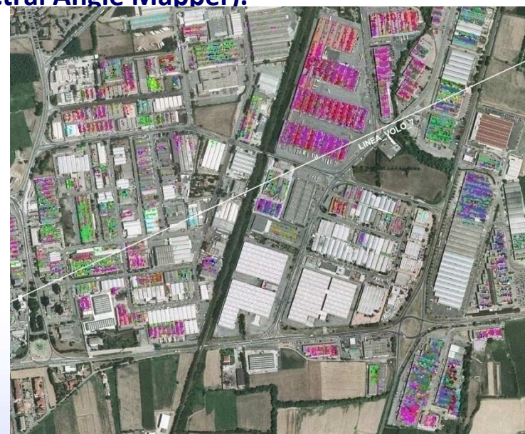
Primo risultato della classificazione: i colori rappresentano diverse tipologie di coperture in cemento-amianto
